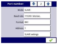
Fig. 7.150. Configuration parameters for SLAVE mode
