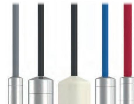
Abhängig vom Verwendungszweck gilt es auch den passenden Mantelwerkstoff des Kabels zu wählen. Generell sind Varianten aus PVC, PUR, FEP und TPE erhältlich. Bei der Auswahl muss die maximale Länge der Kabelinstallation, der Temperatureinsatzbereich und vor allem die Beständigkeit gegenüber dem Messstoff berücksichtigt werden. Für den Einsatz in Ex-Zonen, Trinkwasser und maritimen Anwendungen sind passende Kabel mit entsprechenden Zulassungen erhältlich.
