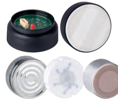
Das Herzstück einer Füllstandssonde bildet der jeweilig verwendete Drucksensor. Dieser lässt sich grundsätzlich in die Gruppe der Edelstahl- oder Keramiksensoren einordnen. Edelstahlsensoren werden vor allem bei Messungen in sauberen bis leicht verschmutzten Flüssigkeiten eingesetzt, während die wesentlich robusteren Keramiksensoren ihre Stärke bei verschmutzten, korrosiven und dickflüssigen Medien ausspielen.
