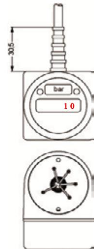
Kabelausgang mit PVC-Kabel<sup>4</sup>
