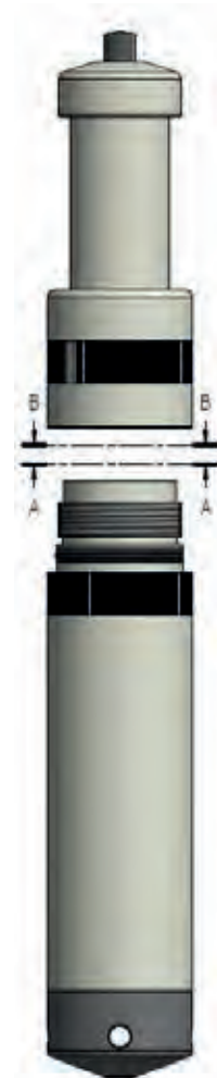
Trennbarkeit von Sonde und Kabelteil
