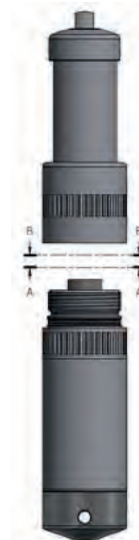
Trennbarkeit von Sonde und Kabelteil
